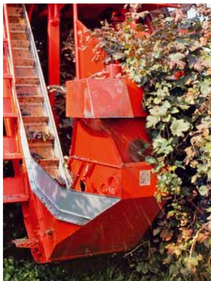
Particolare della macchina in azione: si noti l'apparato di pulizia sul lato destro, con il separatore meccanico e il nastro in gomma per il trasporto del prodotto al serbatoio
