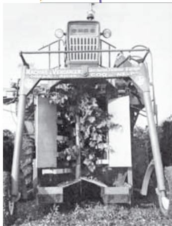
La vendemmiatrice americana a scavallamento Chisolm Ryder, importata agli inizi degli anni 70 dalla francese Coq
