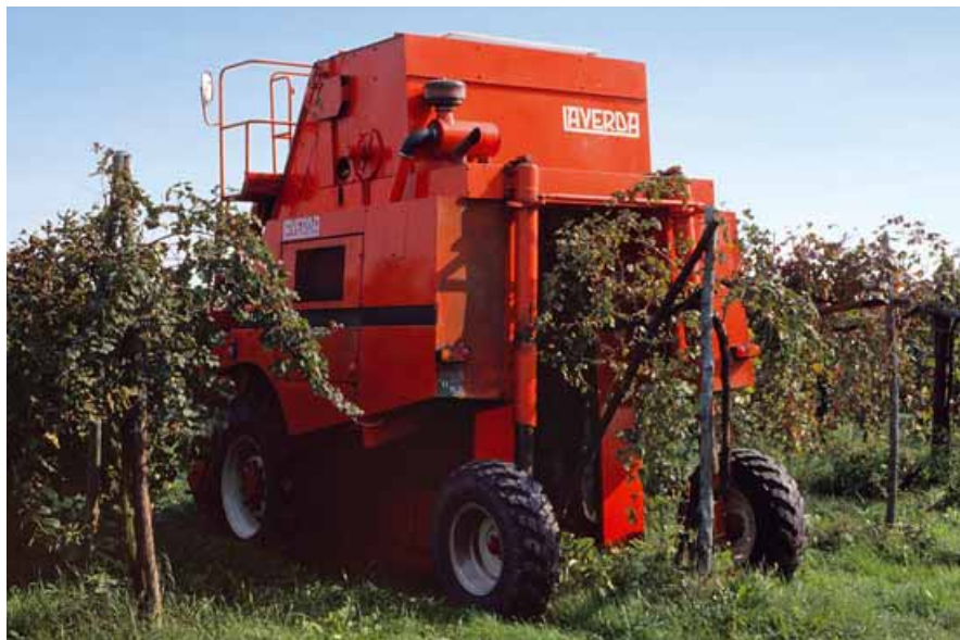
L'ingresso della macchina nel filare: in evidenza il sistema idraulico di sollevamento che permetteva di variare l'altezza di lavoro
