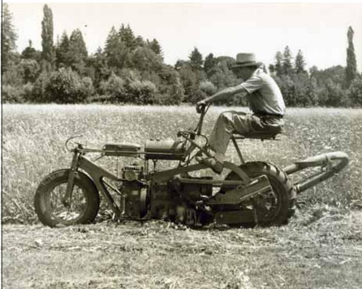
La caratteristica **posizione di guida** con l'operatore che pilota la macchina agendo con i pedali sulla ruota anteriore
