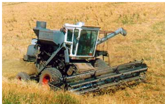
Il più potente dei modelli nordamericani a livellamento integrale Gleaner, la GH1 del 1969 con motore V8 a benzina da 120 CV
