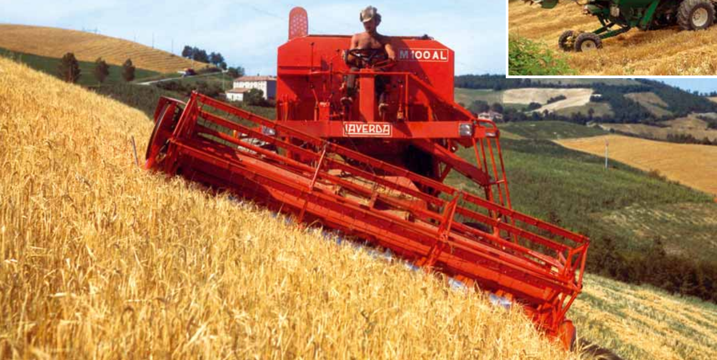
Una Laverda M 100AL in azione nell'Appennino: in evidenza il pronunciato livellamento trasversale (1971)
