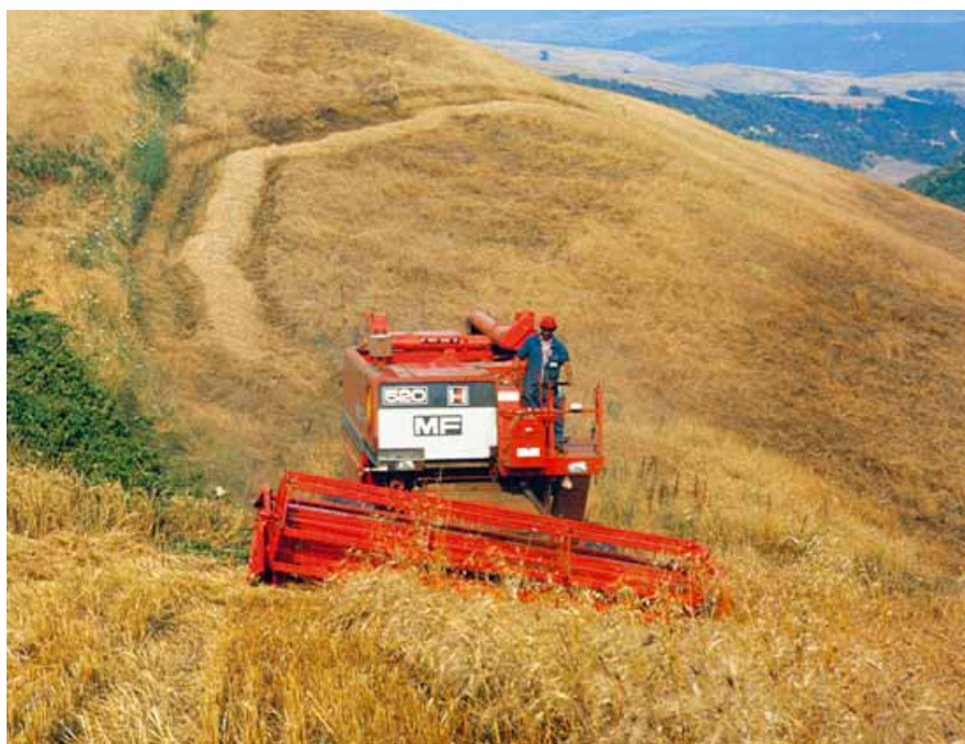
La Massey Ferguson 520 H4 rappresentò la tipica macchina "trasformata" in livellante, negli anni 70, appositamente per il mercato italiano
