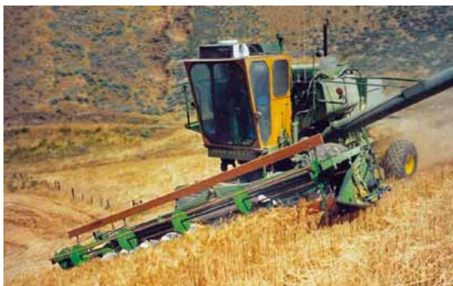
John Deere realizzò nel 1958 una versione autolivellante del modello 95 con il sistema brevettato da R.A.Hanson: la JD95 - Hb
