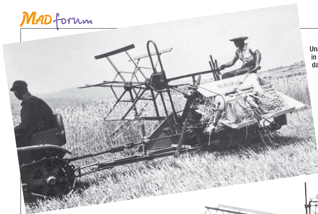
La mietitrebbia trainata Caterpillar Thirty Six con livellamento trasversale manuale
