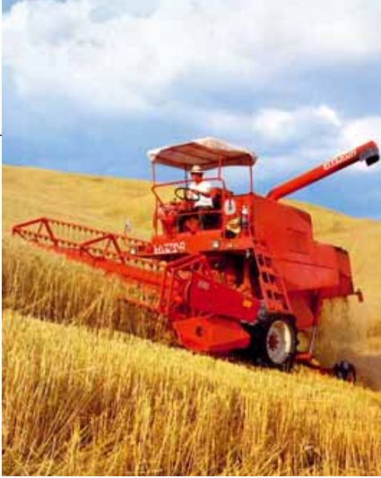
I livellamenti trasversale e longitudinale sono ben evidenziati in questa Laverda M 92AL in azione su grano
