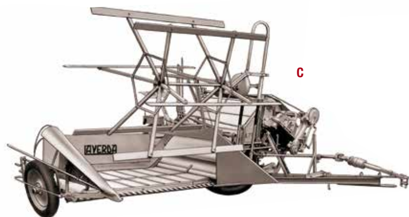
▲ I tre modelli di mietilegatrici Laverda: la ML5 BR (A), la ML6 (B) e la ML7 (C) con azionamento a cardano.
