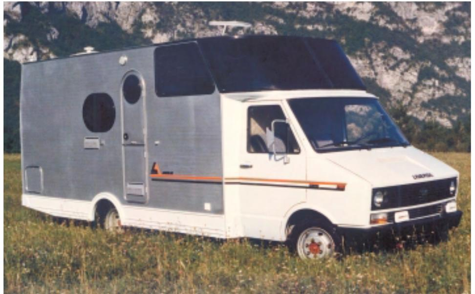
Ci-dessous: la révolutionnaire série Blu, caractéristique par sa forme parallélépipédique et sa grande fenêtre frontale en polycarbonate. A l'arrière, elle pouvait être dotée d'une cloison pliante qui en augmentait davantage l'habitabilité déjà exceptionnelle.
